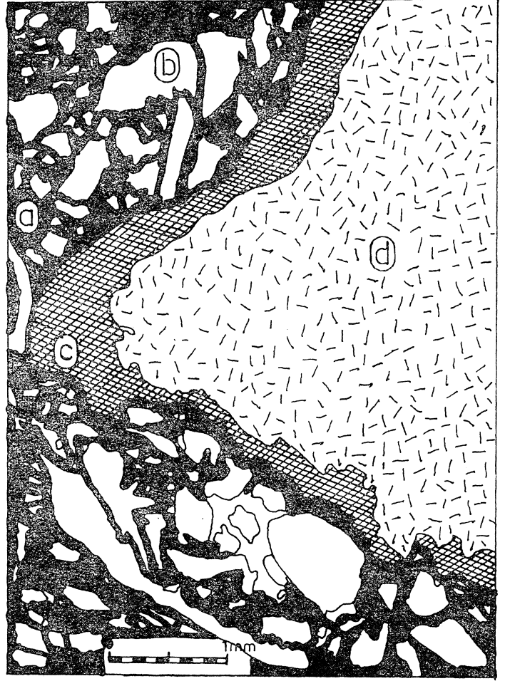
Sekil 9: Bir ofiyolitli melanj olistostromunun mikroskopik görünümü, a) Hamur; b) Çeşitli kayaç parçaları; c) Dokanak çimentosu; d) Diyabaz parçası.
